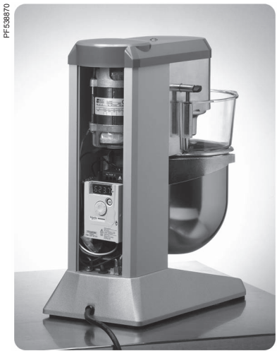
ATV12控制搅拌机
